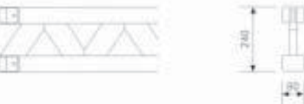
Стык балки при особой длине
